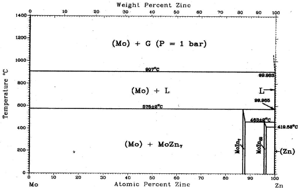
Fig. 6: Mo – Zn – phase diagramm (ASM)
