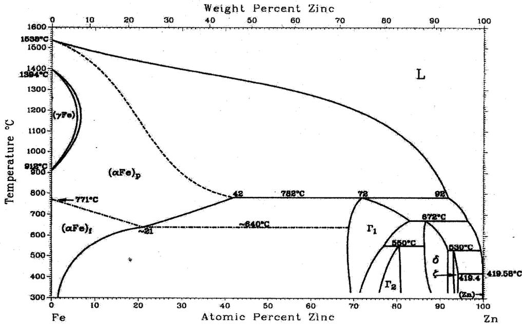
Fig. 7: Fe – Zn – phase diagramm (ASM)
